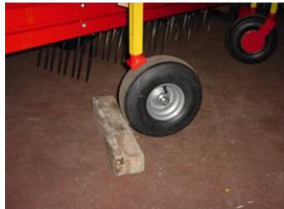
Bei Strassenfahrten müssen die Rückstrahler (vorne weiss / hinten rot) gut sichtbar sein! Den Heuer nicht zu hoch anheben damit bei Nachtfahrten das Licht des Traktors nicht verdeckt wird. Eventuell Dachscheinwerfer am Traktor montieren.
