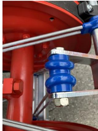
Das Gewinde der Schraube sollte ca. 2-3 mm in der Mutter vorstehen. Dies ist wichtig, da sich das Gewinde der Schraube in den ersten Betriebsstunden im Keilriemen einlaufen muss.
